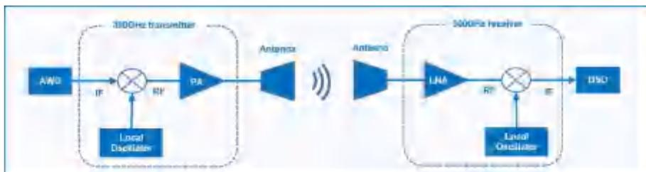
图 4.2 全固态电子混频方案示意图
